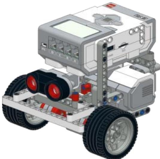
Базовая конструкция робота для кегельринга.
